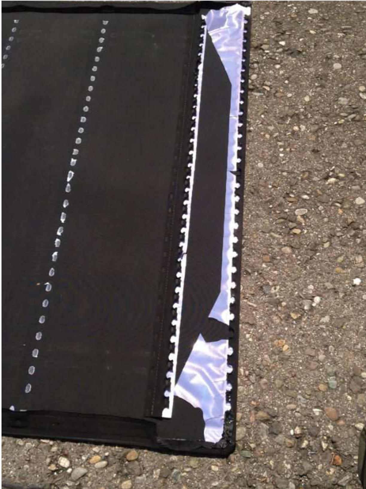
Beim Neu-Aufbau, siehe Bildfolge, wird die Verbindung zwischen Verdeckstoff und Unterbau intensiver weil die Verbindung drei Zentimeter breit ist! Dies ist zur Zeit die Qualität wie Cabriodächer hergestellt werden. Vor allem ist es wichtig, dass die
