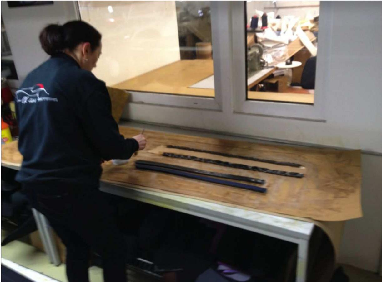
***Die separaten Verstärkungen, die sich unter den Metallbügeln befinden, werden hier erstmals mit Kleber bestrichen.***
