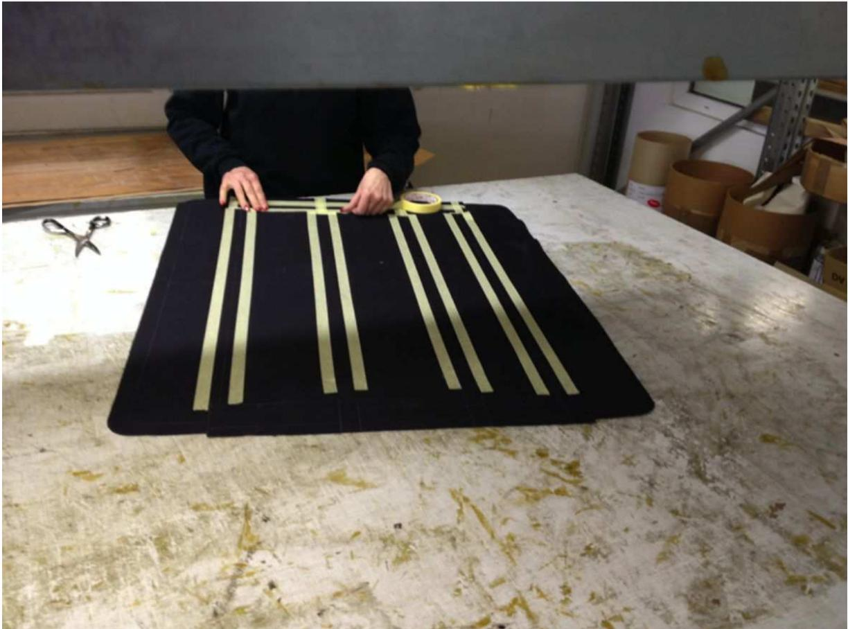
*Die Klebebahnen werden auf den Zuschnitt übertragen*
